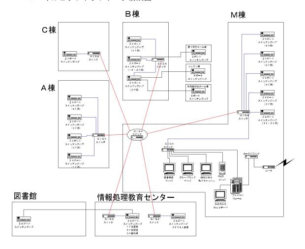
基幹線の通信速度が 1Gbps の学内 LAN は、ロードバランサの自動切り替えにより SINET 接続または 0CN 接続により学内全域の教室、研究室、管理室までのネットワーク化を図り、教育研究及び学習支援にインターネットを活用すると同時に、図書館の蔵書検索にも Web を活用することができる。学生は、学内で無線 LAN によりネットワークに接続することもできる。また、設置されているコンピュータはすべてネットワークに接続されており、インターネットの閲覧や、Web に掲載された休講情報の確認、図書館の所蔵図書の検索等のサービスを利用できる。また、学生が 0WCNET に個人端末を新規接続する場合、情報処理教育センターに「0WCNET 接続申請書」を提出することで、IP アドレスやメールアカウントなど必要なデータを得ることができる。
